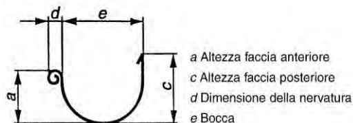
FIG. 5 - Canale di gronda - Tipo
